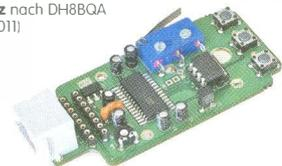
Speichert bis zu 60 Sekunden lange CQ-Rufe. Ideal für Conteste, QRP- und Urlaubseinsatz. Austauschplatine für die Yaesu-Mikrofone MH-31 (FT-817/857/897, FT-950 usw.). Durch Jumper-Feld auch an Kenwood- und Icom-Transceivern nutzbar.
