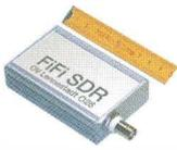
Speisung und Steuerung vom PC aus über USB. Firmware-Updates ganz einfach via Internet und PC möglich. Kompletter Bausatz mit SMD-bestückter Platine, Gehäuse usw.
