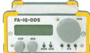
High-End-DDS mit IQ-Ausgängen für 10 Hz...165 MHz. 2 Kanäle (0...360° einstellbar), 500-MHz-Takt, USB-Anschluss und viele weitere Features für EME und weitere anspruchsvolle Anwendungen
