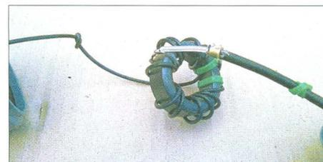
Bild 4: Breitband-Spartransformator mit Kabelbinder am RG58 zur Zugentlastung
