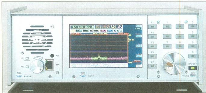
Sowohl der hier zu sehende RDR54 als auch der RDR50 sind in robusten Aluminiumgehäusen untergebracht. Der RDR50 ist vollständig via Touch-Display steuerbar.
