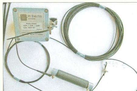
Auch Mehrbandantennen lassen sich über einen hochohmigen Unun-Transformator am Ende speisen. Der Autor stellt fertig erhaltene Antennen aus den Niederlanden vor und gibt oben-dreien Hinweise für den Selbstbau. Foto: DL6RAL 65
