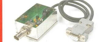
Bausatz mit AD8307, bearbeitetem Weißblechgehäuse, BNC-Einbaustecker, Anschlusskabel usw.
