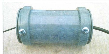
Bild 5: In einer HT-Rohrmuffe montierter Breitbandübertrager
