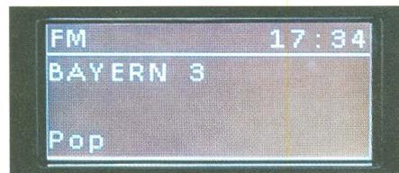
**Bild 5: Terratecs Noxon dRadio 110 empfängt auch UKW-Hörfunk.**
