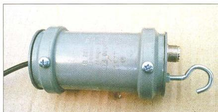
Bild 3: Gleichtakt-drossel im montierten Zustand mit Blechtreiberschrauben zur Fixierung
