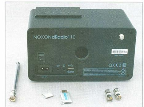
**Bild 2:** Rückseite des Noxon dRadio 110 mit Antenne, USB-Stift und Adaptern für Außenantennen
