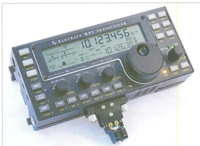
**Bild 1:** Der betriebsbereite KX3 mit CW-Paddel KXP3, das sich ohne Werkzeuge anschrauben lässt. Bei Tageslicht kommt der KX3 dank reflektivem Display, wie hier zu sehen, sehr gut ohne seine (nicht in ihrer Intensität veränderliche) Hintergrundbeleuchtung aus, was etwa 20 mA spart.
