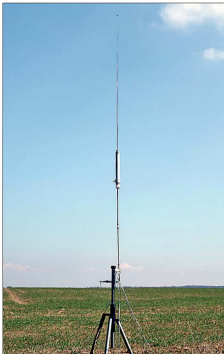
Bild 1: Portabelantenne für KW; HF-P1 auf einem Dreibeinstativ
