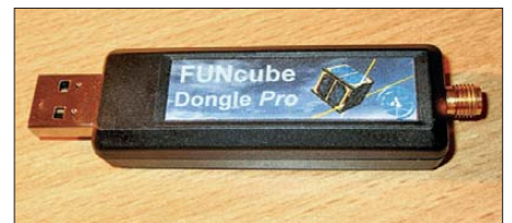
Bild 10: Der FUNcube verfügt über einen SMA-Antennenanschluss und kann direkt in eine freie USB-Buchse des PC gesteckt werden. Aus mechanischen Gründen empfiehlt es sich allerdings, ihn über eine kurze USB-Verlängerung mit dem PC zu verbinden.
