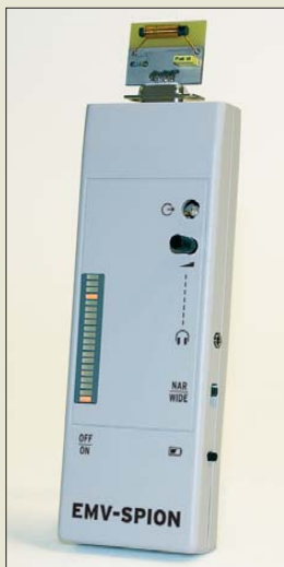
Das Gehäuse des EMV-Spions, hier mit aufgesteckter Sonde, ist bedruckt und mit allen Durchbrüchen versehen.
