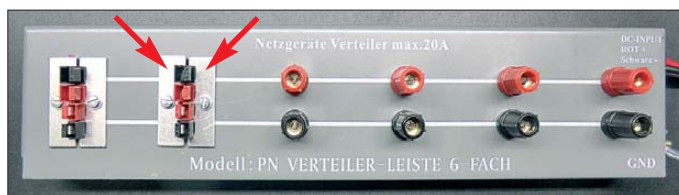
Bild 2: Jeweils vier Powerpole-Steckverbinder werden mit zwei Einbaurahmen festgehalten. Fotos: DL6OLI
