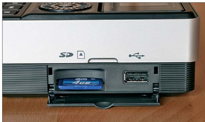
Bild 5: Die beiden Schnittstellen für SD/SDHC und USB liegen unter einer seitlichen Klappe. Die USB-Buchse dient nur als Eingang für Speichermedien, um darauf gespeicherte Audiodateien (MP3 und WMA) über den DAR-101 wiederzugeben. Fotos: DE&JOI
