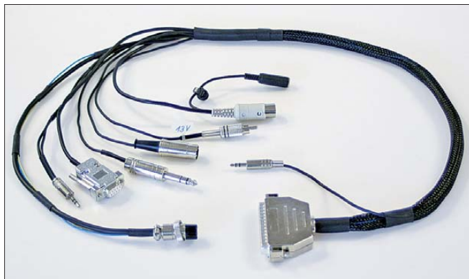
Bild 1: Selbst gebautes Verbindungskabel für den Anschluss des FT-1000MP an den micro Keyer II. Der Schlauch aus Polyestergeflecht hält die Anschlussleitungen zuverlässig zusammen und ist auch optisch ansprechend.
