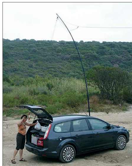
Bild 6: XYL Verzhynia am Pkw; im Hintergrund der GFK-Mast für die als Inverted Vee abge-spannte G5RV-Antenne Fotos: DL8JJ
