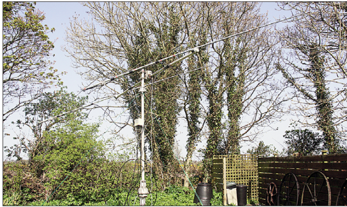
Bild 3: Selbst an ungünstigen Standorten wie hier im vegetationsgesäumten Garten ist recht erfolgreich EME-Betrieb in JT65 möglich. Das Bild zeigt den Aufbau von MD/DH7FB und MD/DF2ZC im April 2011.
