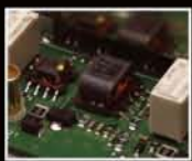
Die 1. Mischstufe sorgt für optimale Empfangereigenschaften
