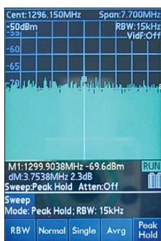
Bild 5: Störnebel am Plastikstecker des HDMI-Kabels A
