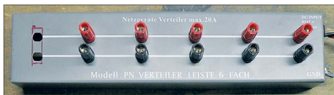
Bild 1: Von der Verteilerleiste sind zwei Laborklemmen zu entfernen und ein Durchbruch für vier Powerpole-Verbinder herzustellen.
