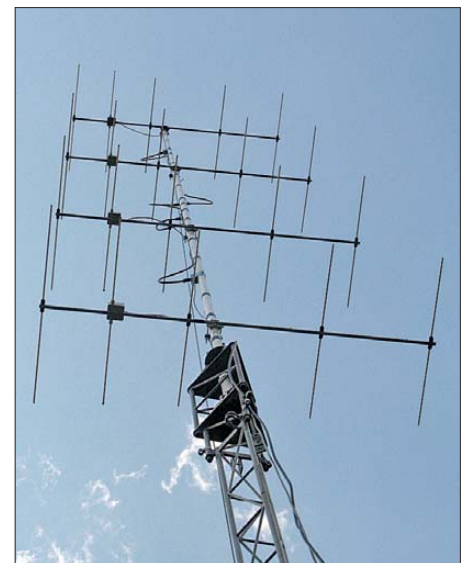
Bild 7: Die 4 × 25-Ω-Yagigruppe bei DA0Y (DK5EW)
