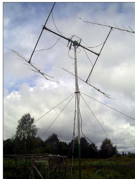
Bereit zum Funkeinsatz: die 4 x 8-Element-Gruppe des EW-DXpeditionsteams in KO42AQ
