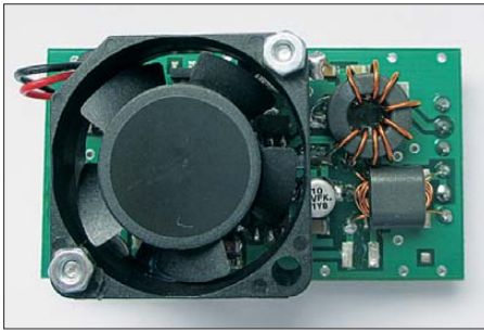
Bild 1: Musteraufbau des 4-W-Moduls mit Lüfter auf der Platine mit den Abmessungen 50 mm x 30 mm
