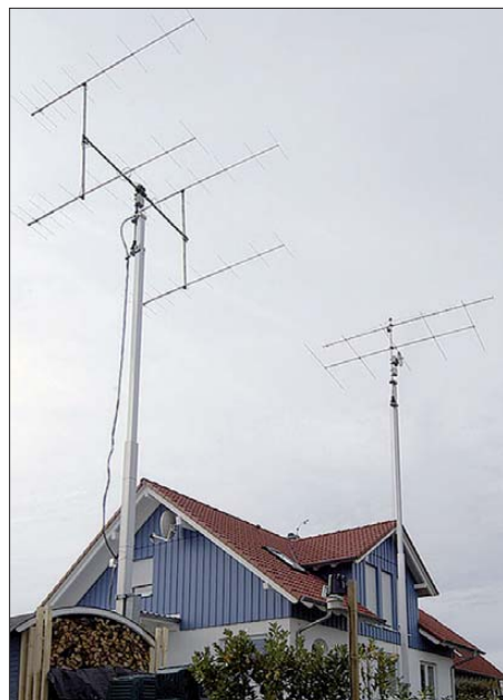
Die 4 × 9-Element-Gruppe von Udo, DK5YA. Im Hintergrund eine 5-Element-10JXX für 50 MHz und eine 25-Element-10JXX für 70 cm Foto: DK5YA
