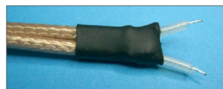
Bild 3: Selbst hergestellte 100-Ω-Leitung
