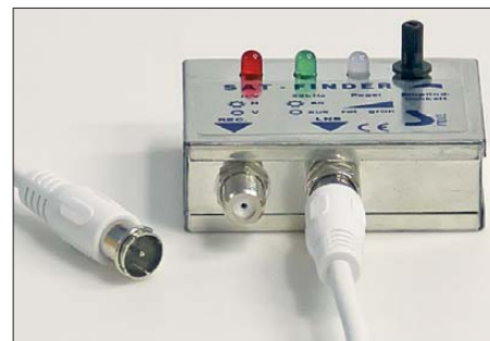
Bild 9: Der preisgünstige Sat-Finder wird am LNB in die Leitung zum Receiver bzw. zur Hausverteilanlage eingeschleift.
