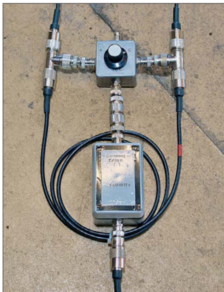
Bild 5: Ansicht der Schaltbox mit den beiden T-Stücken und der dazwischen angeordneten aufgewickelten Phasenleitung; die Box darunter beinhaltet den 1:1-Strombalun.
