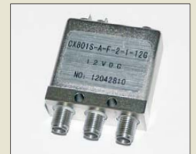
Das CX801S ist mit drei SMA-Buchsen ausgestattet.
