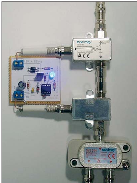
Bild 1: Aufbau in der Praxis; die untere Stromeinspeiseweiche muss um 180° vertikal gedreht eingebaut werden, da der Gleichstromweg ansonsten gesperrt ist. Foto: DL1MK
