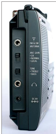
Bild 3: Anschlussbuchsen, Antennenabschwächer, Tonblende auf der linken Geräteseite
