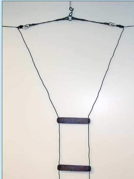
Bild 18: Dieser Dipol mit Hühnerleiter aus dem Surplus (ex NVA) ist von vornherein für die Abspannung als Inverted Vee ausgelegt. Zwischen den beiden Isolatoren befinden sich Seilstücken mit einer Öse zum Aufhängen.
