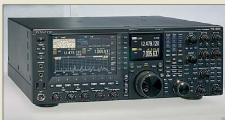
Der FA durfte es ohne Plexiglashaube fotografieren: Kenwoods neues KW- und 6-m-Schlachtschiff TS-990.
