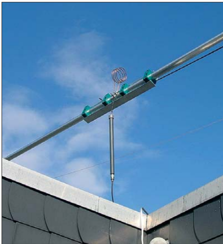
Bild 11: Der mitgelieferte 3-kW-Strombalun 1:1 unterdrückt Mantelwellen und erinnert an die Modelle von CAL-AV-Labs.
