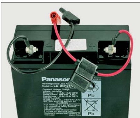
Bild 2: Typische Bauform eines Bleigel-Akkumulators; zwei Exemplare dieses Typs dienen als Stromquelle für den Portabelbetrieb mit dem IC-706MKIIG.
