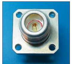
Bild 12: Auch bei der Buchse liegt die genormte Bezugsebene (rot) an der Stoßkante des Außenleiters.
