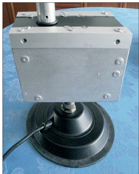
Bild 3: Magnetfuß mit dem aufgesetzten, selbst hergestellten Rotor
