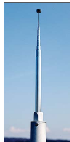
Bild 6: Das oberste Antennenelement der HF-P1 ist ein Teleskopstab.
