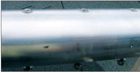
Bild 5: Diese Art und Weise der Verschraubung kennt man auch von Optibeam ... Alle Schrauben sind Edelstahlexemplare mit Zylinderkopf sowie selbstsichernden Muttern.
