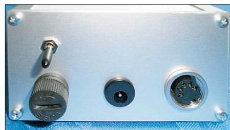
Bild 8: Auf der Rückfront der Steuereinheit befinden sich Beleuchtungsschalter, Sicherung, Spannungs- und Anschlussbuchse.
