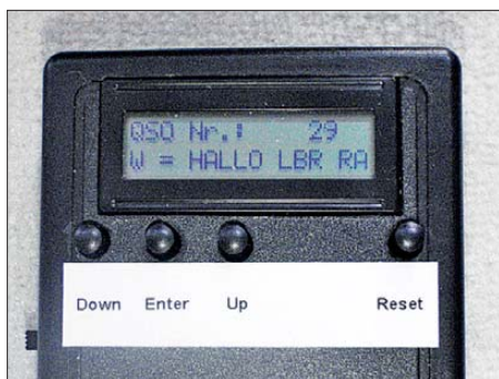
Bild 7: Während der akustischen Ausgabe der Telegrafiezeichen ist der Text auf dem LC-Display lesbar.
