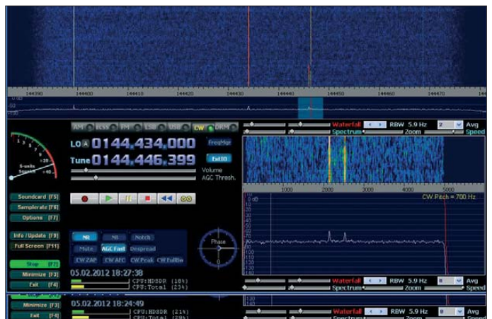
Bild 5: Screenshot von HSDR beim Bakenempfang im 2-m-Band; hier wird die Leipziger Bake DB0LBV empfangen. Fotos und Screenshots: DL2LUX
