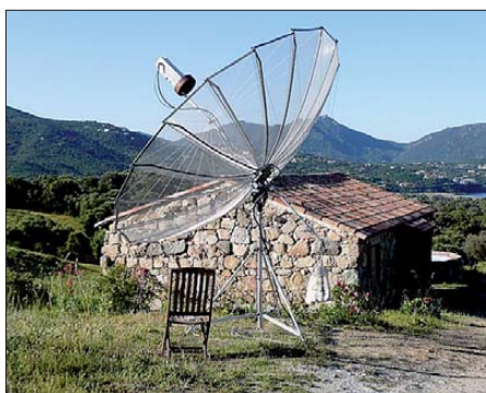
Spiegel und Feed für 1296 MHz bei TK/DL1YMK
