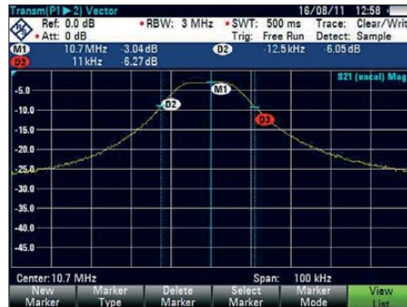
Bild 19: Einfügedämpfung des Quarzfilters
