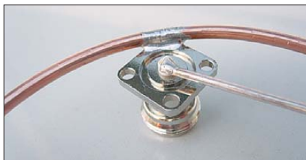
Bild 2: Lötverbindung von N-Buchse und Strahlermitte sowie Anschluss der Gamma-Leitung
