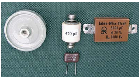
Bild 2: Beispiele für Kondensatoren, die in Röhrenendstufen eingesetzt werden können; oben links ein russischer 10-kV-Scheibenkondensator, in der Mitte ein sogenannter 6-kV-Doorknob („Türknope“), oben rechts ein 1-kV- und unten ein 500-V-Glimmerkondensator
