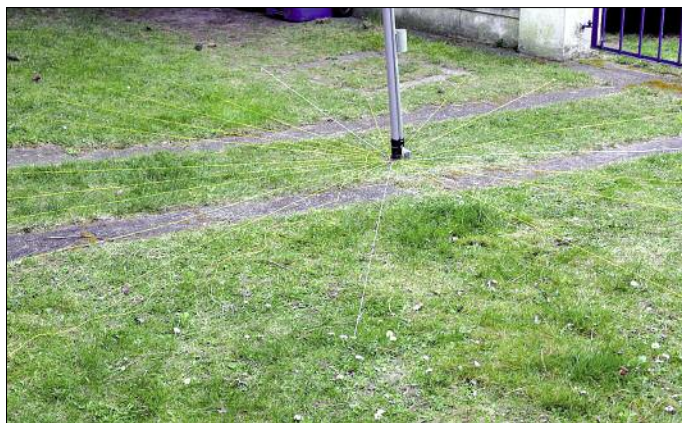
Die etwa 20 knapp 2 m langen Drähte des Gegengewichts der 2-V-Antenne lassen sich dank der etwa 5 cm langen Dachpappennägel in kurzer Zeit sternförmig auslegen.
