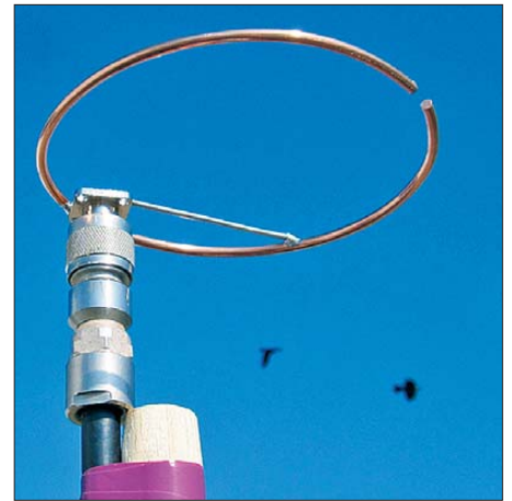
Bild 4: Testaufbau der fertigen Halo-Antenne an einem Besenstiel aus Holz; das Isolierband ist nur mit leichtem Druck um das Koaxialkabel gewickelt. Fotos: DH8AG
