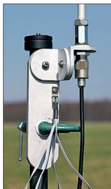
Bild 5: Montagewinkel mit Antenne, Koaxialkabel und vier Radialen
