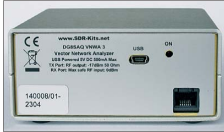
Bild 2: An der Geräterückseite befinden sich noch zwei Buchsen; USB für die Verbindung zum PC, RJ-11 zur Rotorsteuerung und für ein S-Testset sowie ggf. zur Stromversorgung.
