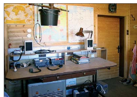
Stationstisch in der Hafelekarhütte des ÖVSV-LV Tirol; oben links die Antennendrehvorrichtung für die VHF/UHF-Antennen
