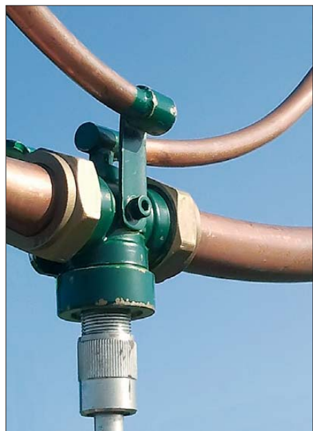
Bild 5: Einkopplung unter Verwendung eines T-Stücks; ein Ende der Koppelschleife ist hier geerdet.
