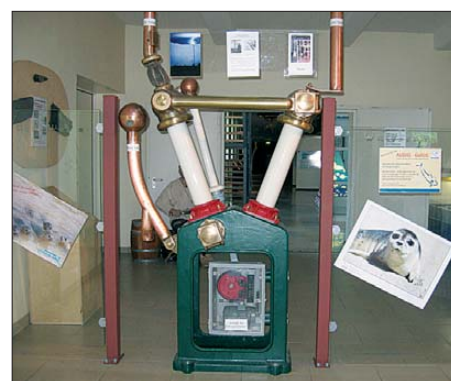
Bild 8: Dieser Erdungsschalter dürfte für Amateurfunkanwendungen mehr als eine Nummer zu groß sein.
