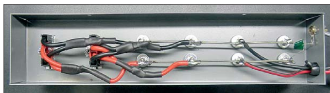
Bild 3: Im Innern des Gehäuses sind die gecrimpten Kontakte über isolierten Leitungen mit den bestehenden Drähten zu verlöten.
