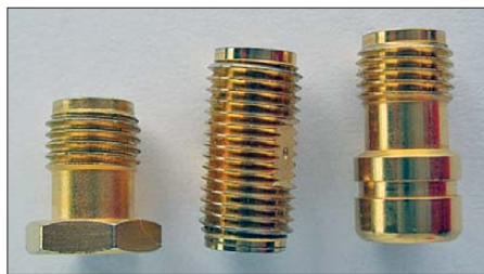
Bild 9: SMA-Kalibrierelemente ( female ) von Rosenberger: Short , Open/Thru , Load (v.l.n.r)
