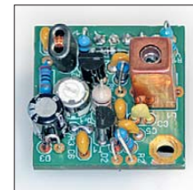
Bild 10: ZF-Verstärker im Weißblechgehäuse auf der Grundplatte
