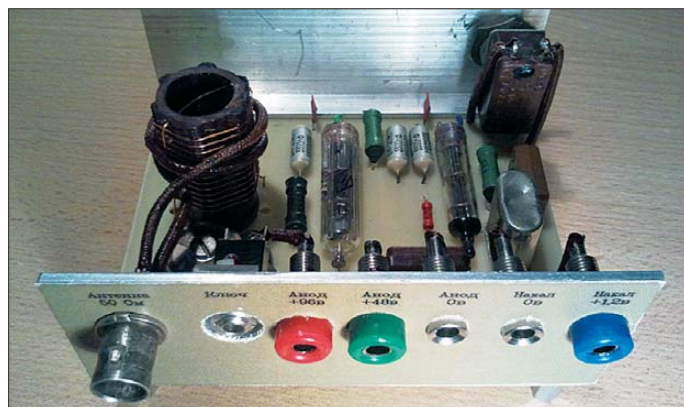
Bild 1: Blick schräg von oben auf den Laboraufbau des überwiegend aus russischen Bauteilen bestehenden Senders; sogar die Frontplatte wurde in Russisch beschriftet. Die grüne Buchse „Anod +48 V“ hat keine Bedeutung und bleibt frei.
