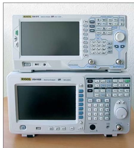
Bild 2: Die Spektrumanalysatoren DSA815-TG (o.) und DSA1020 vom chinesischen Hersteller RIGOL weisen dank moderner Bauelemente sehr gute technische Daten auf.
