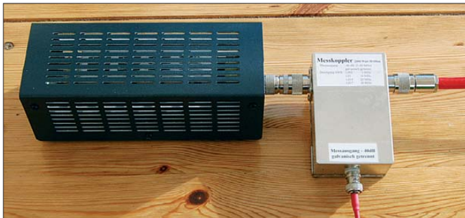
Bild 1: Fertig aufgebaute Messkopplers (r.) mit angeschlossenem Lastwiderstand
