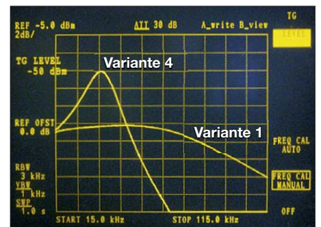
Bild 8: Signalpegelverlauf von 15 kHz bis 115 kHz im Vergleich der Varianten 1 und 4
