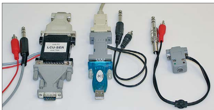
Bild 1: Drei Interface-Lösungen für einen Yaesu-Transceiver mit RS232-Buchse: links LCU-SER mit Sub-D25-Steckern (2000), Mitte BX-009 mit USB/RS232-Adapter (2007) und rechts die hier beschriebene Variante (2012)
