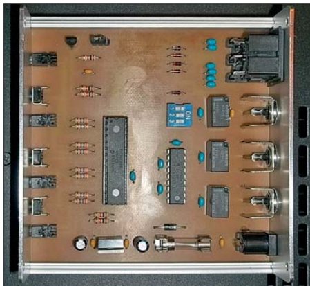
Bild 1: Musteraufbau des Komfort-Sequenzers; wegen der geringen Bauteildichte dürften auch Lötanfänger keine Probleme beim Nachbau haben.
