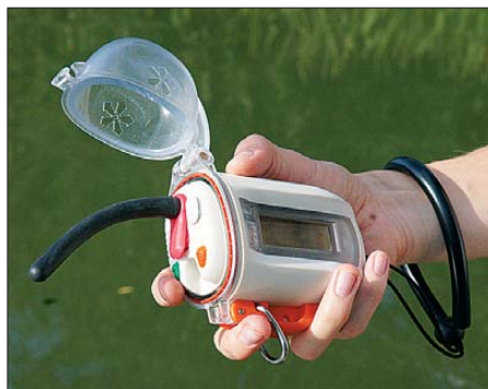
Die Sprechasten sind etwas klein geraten. Das Display zeigt den aktuellen Längen- und Breitengrad, den Ladezustand des Akkumulators sowie den eingestellten Seefunkkanal. Das Funkgerät ist auch mit offener Abdeckung wasserdicht. Fotos: Hub
