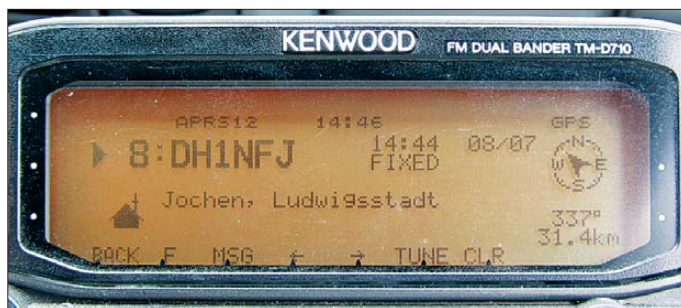
Bild 8: Nur mit GPS-Empfänger werden die korrekten Richtungen und Distanzen zu den anderen Stationen sichtbar. Die 31 km zu Jochen, DH1NFJ, nach Ludwigstadt sollten sich überwinden lassen.
