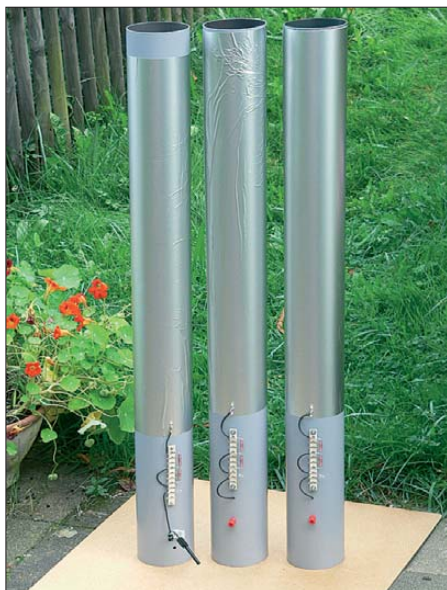
Bild 6: Jedes dieser Kunststoffrohre enthält eine Serienschaltung aus Anzeigelämpchen, Induktivität und Folien-EPK (s. Text).
