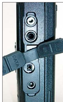
Bild 3: Ein ganzes Arsenal von Buchsen bietet die rechte Seite: für Mikrofon und Lautsprecher in bekannter Norm, Datenkabel und Lade- bzw.
