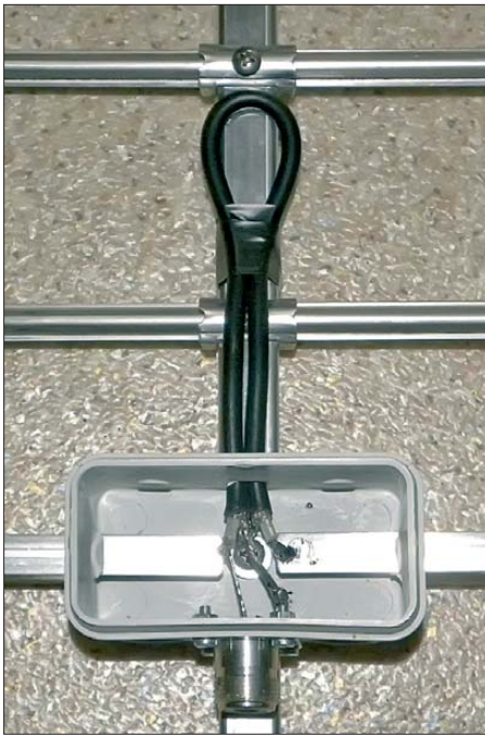
Bild 2: Die neue Anschlussdose mit N-Buchse und Balun
