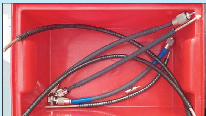
Bild 31: Diverse Mantelwellensperren aus über das Koaxialkabel geschobenen Ringkernen
