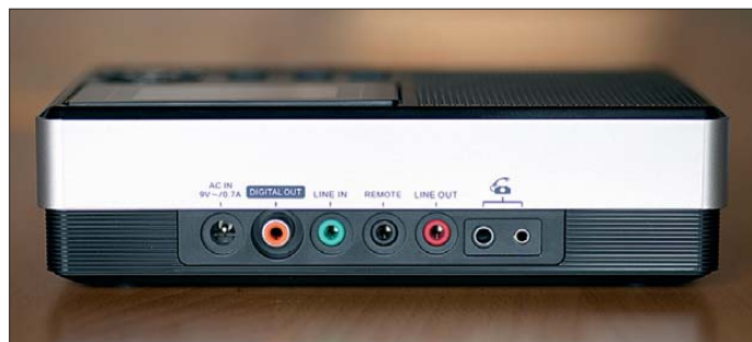
Bild 3: Anschlussbuchsen auf der Rückseite
