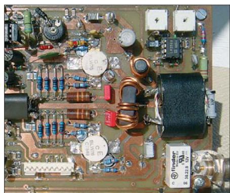
Bild 4: Bestückte Leistungstransistoren und Ausgangsübertrager im Musteraufbau des 20-W-Verstärkermoduls (27-V-Version)
