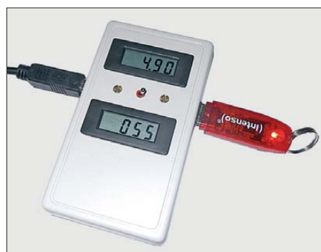
Bild 1: Ansicht des aufgebauten Musters; der angeschlossene USB-Stick zieht 55 mA. Foto: Riedel
