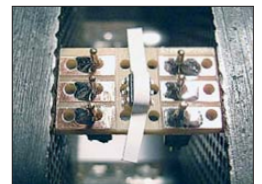
Bild 5: Fixierung des ATtiny10 auf der Adapterplatine mit einem Streifen Isolierband
