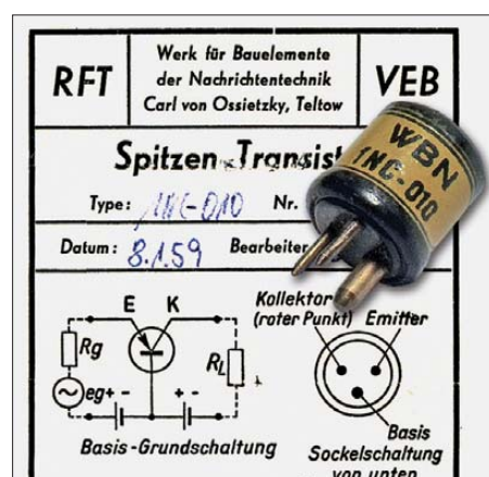
Bild 2: Spitzentransistor von 1959 mit handbeschriftetem Datenblatt – mni tnx DL1HUB!
