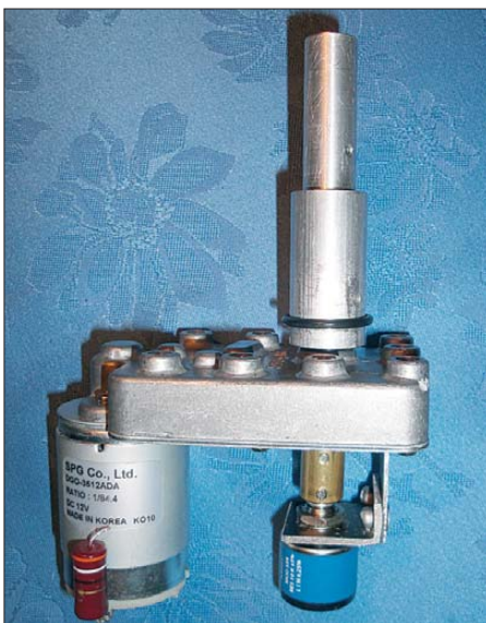
Bild 6: Getriebemotor mit angesetztem Aluminiumreduzierstück und Potenziometer
