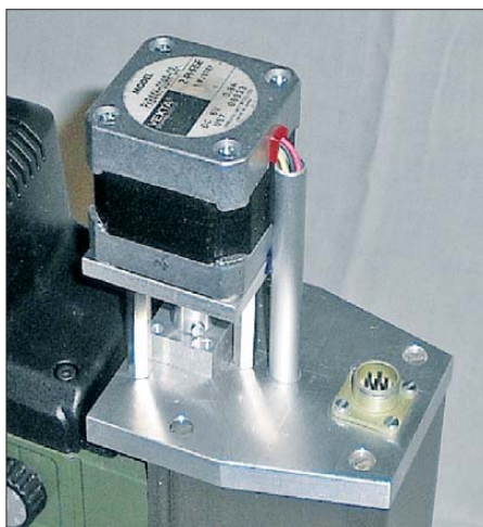
Bild 7: Ansicht des an der Z-Spindel montierten Antriebs; hier noch ohne Notastaster
