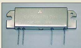
Das RA30H1317M1 liefert von 135 MHz bis 175 MHz bis 30 W bei 12,5 V.
