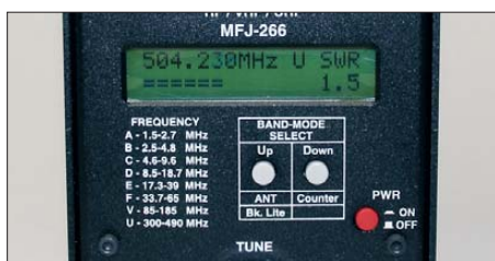
Bild 3: Im 70-cm-Band werden weder Impedanz noch Wirk- und Blindanteil angezeigt, dafür gibt es aber einen groben Bargraph für das SWV.
