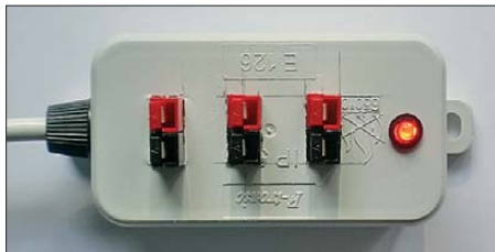
Bild 1: Die Blinkfrequenz im Powerpole-Verteiler mit Spannungsüberwachung informiert über die Spannungshöhe.
