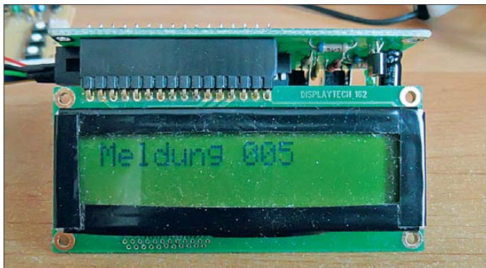
Bild 2: Der Wannenstecker links dient zur Programmierung und zur Kopplung mit dem Zweidrahtbus.
