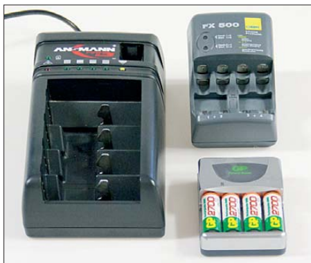
Bild 1: Beim Laden von modernen Akkumulatoren ist zu prüfen, ob das Ladegerät den benötigten Strom aufbringen kann. Foto: FA
