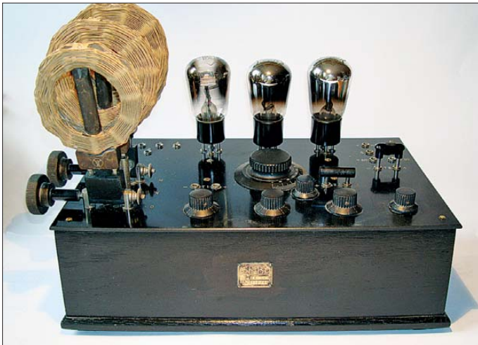
Bild 1: Gut erhaltener und fachmännisch restaurierter historischer Empfänger mit schwenkbaren Wabenspulen aus der Sammlung von Horst Siegmund, DL1XR
