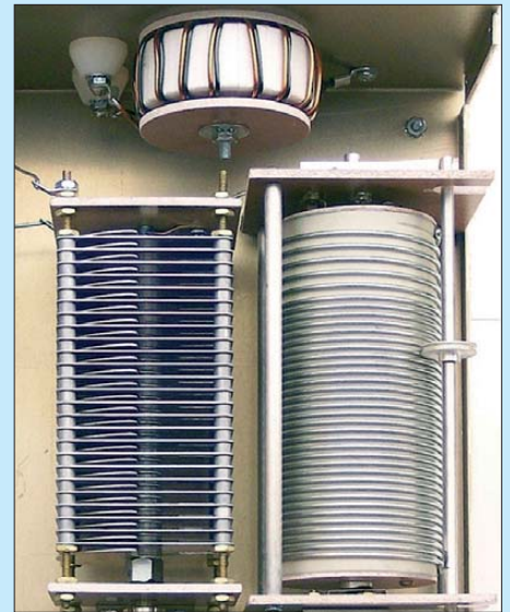
Bild 27: Unsymmetrischer Antennenkoppler Palstar AT1KM mit Differenzialdrehkondensator (links, das zweite Statorpaket ist hier unter dem ersten nicht leicht zu erkennen) und Rollspule; oben 1:4-Balun
