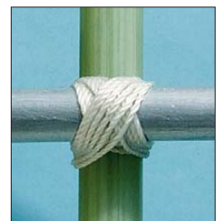
Bild 12: Einfache Befestigung der Elemente auf dem Querträger mit einer 1,5 mm dicken Schnur Fotos: DG0KW
