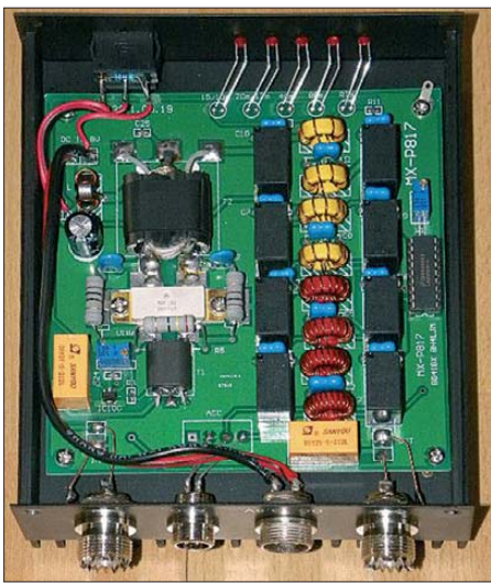
Bild 3: Innenaufbau der direkt aus China bezogenen Endstufe MX-P817
