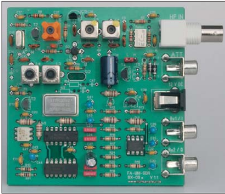
Bild 3: Bestückte Leiterplatte eines Uni-SDR für den FT-950/2000; alle Filterspulen sind große Ausführungen.
