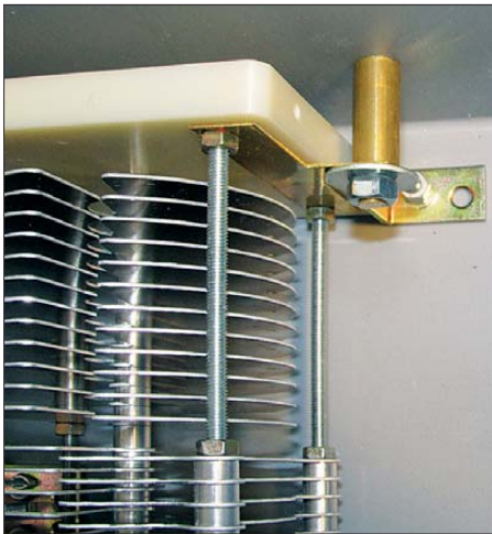
Bild 6: Distanzstück zur Verbindung von Abstimmkondensator mit Senderahmen
