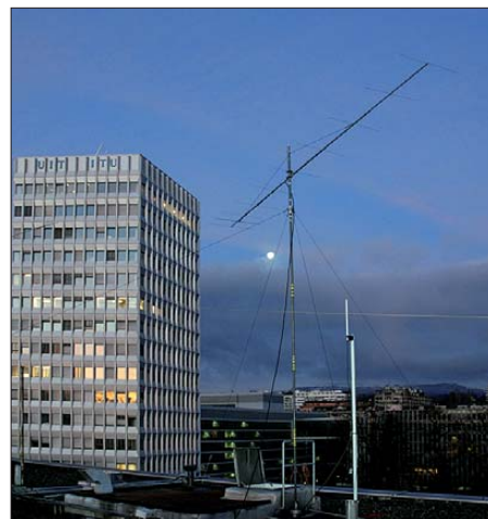
Chris, PA2CHR, war vor fünf Jahren das letzte Mal auf 2 m mittels Meteorscatter von 4U1ITU QRV. Hier die 10-Element-DK7ZB-Yagi-Antenne auf dem Dach des ITU-Gebäudes. Foto: PA2CHR
