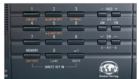
Bild 6: Frequenzen lassen sich nach der Wahl des Wellenbereichs bequem per Zifferntastatur eingeben. Fotos: DE8JOI
