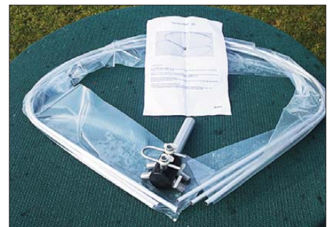
Bild 3: Die Big-Wheel-Antenne für 2 m von [4] besteht aus einem Mittelteil nebst Abgleichbügel sowie drei Schleifenelementen.
