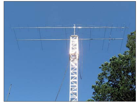
DG0UHF arbeitet auf 2 m mit 100 W an einer 18-Element-M 2 , 17 m hoch am Mast. 4 m darunter befindet sich eine 7-Element-M 2 für 50 MHz.
