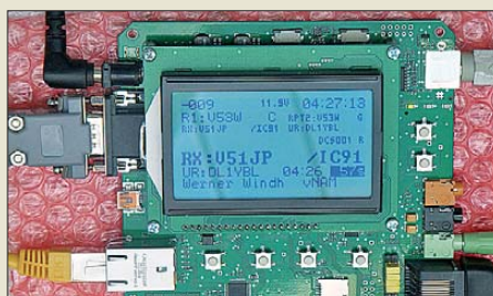
Genial digital: die universelle, frei programmierbare Plattform für digitalen Amateurfunk „UP4DAR“, konstruiert von Michael Dirska (DL1BFF) und Denis Bederov (DL3OCK)
