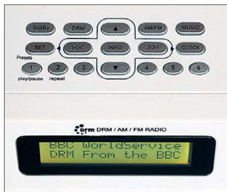
Bild 2: Bedientastenfeld auf der Oberseite des DR111
