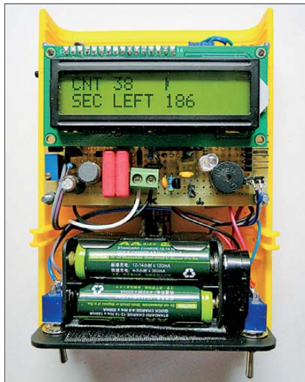
Bild 2: Geigerzähler mit Dosismessung, Frontplatte noch nicht aufgesetzt
