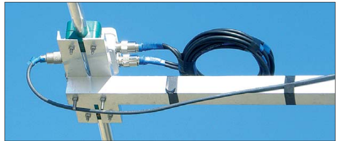
Bild 6: Kabeldrossel für 12 m mit 5-mm-CaTV-Koaxialkabel und PL259-Steckern für RG213-Kabel
