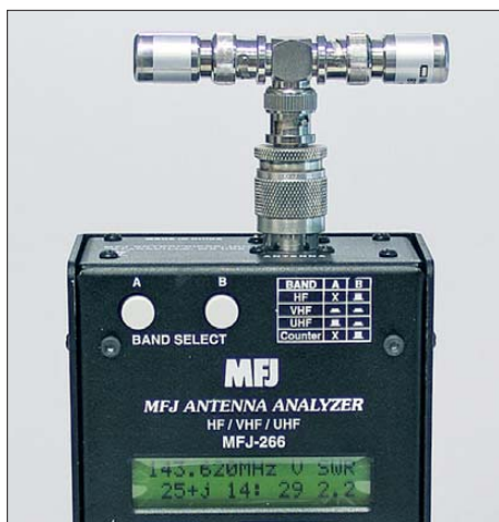
Bild 2: Die Zusammenschaltung zweier kommerzieller 50-Ω-Widerstände mit Verbindungsstücken in Amateurqualität lässt keine exakte 25-Ω-Anzeige erwarten; der angezeigte Blindanteil ist aber zu hoch.
