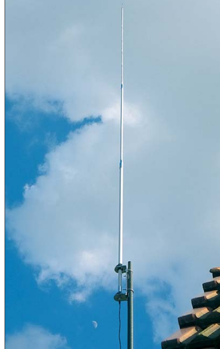
Bild 4: KFA-5000 auf 28,5 MHz abgeglichen
