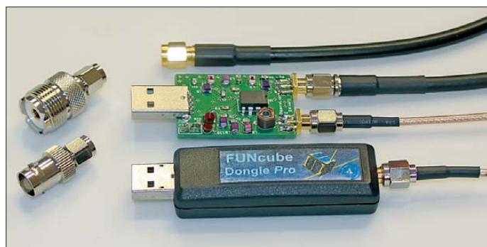
Bild 1: Der FCD (u.) besteht aus einem zweiteiligen Kunststoffgehäuse, das die Leiterplatte mit sämtlichen Bauelementen trägt. In der Bildmitte ist der KW-Konverter zu sehen, der als vorbestückter Bausatz geliefert wird.
