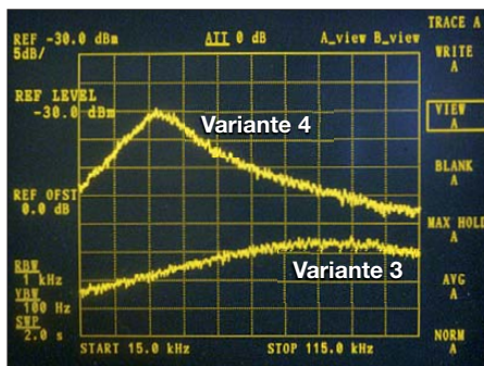
Bild 5: Störverhalten der Varianten 3 und 4 bei EM-Bestrahlung
