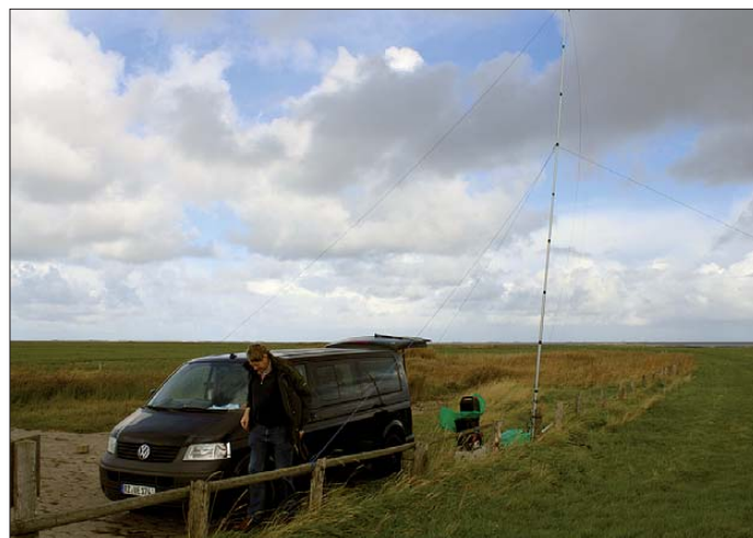
DL0DFF im Kleinbus am Südufer der Hallig; als Antenne kam eine Vertikal, die aus einem 8 m langen Draht und einem einfachen Erdnetz bestand, zum Einsatz.
