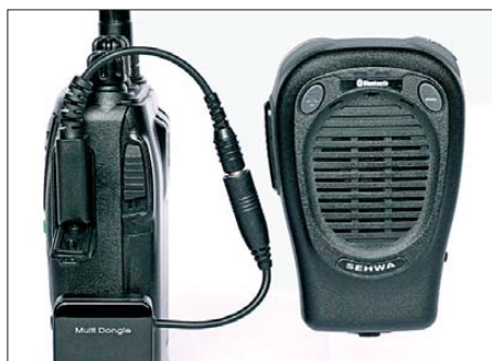
Empfangs- und sendebereit ohne Kabelsalat: Die Lautsprechermikrofone von Sehwa sind drahtlos per Bluetooth angebunden.
