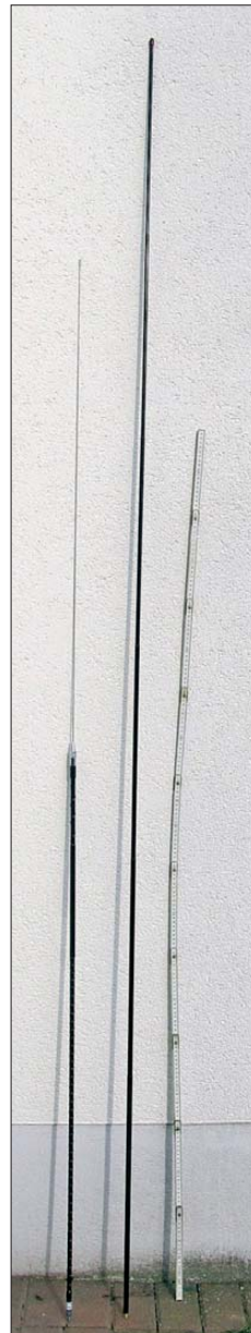
Bild 6: C-Whip-Monoband-Mobilstrahler f6r das 20-m-Band (links) und Teleskopantenne (Mitte) im Gr66envergleich neben einem Gliederma6stab (2 m, rechts) Fotos: DL6RAL
