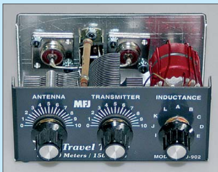
Bild 29: MFJ-902 – relativ kleiner („Reiseausführung“) unsymmetrischer Antennenkoppler mit Spulenabgriffen; Schalten unter Last ist gerade bei diesem Winzling unbedingt zu vermeiden!
