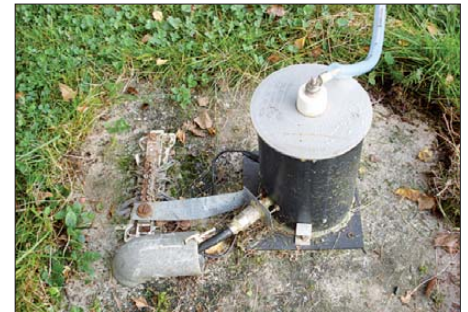
Bild 11: Verbesserte Ausführung des Fußpunkts mit Keramikisolator Fotos: DK6ED
