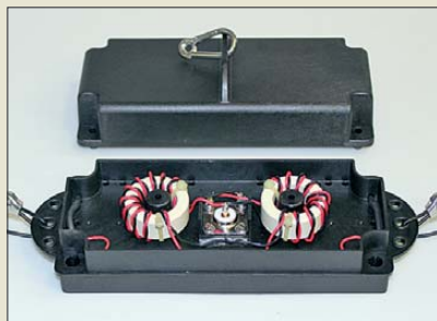
Geöffnetes Balungehäuse BAGB-180, hier mit zwei Ringkernen für 750 W und den außen befestigten Drähten einer Windom-Antenne
