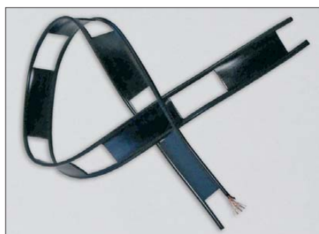
Bild 1: Die klassische US-Wireman-Zweidrahtleitung gibt es in 450- \Omega -Ausführung (CQ553, 23 mm breit, Foto) und in 300- \Omega -Ausführung (CQ562, 11 mm breit) u. a. bei [4].
