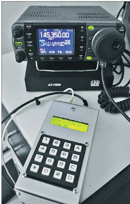
Bild 1: Das Muster der Tastaturbaugruppe steuert einen IC-7000. Foto: DF9ZO
