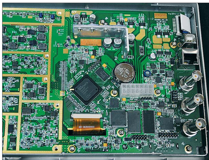
Bild 14: Leiterplatten-ausschnitt mit ZF- und Digitalteil des DSA815-TG
