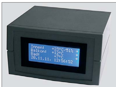
Bild 2: Basisstation des Datenloggers in einem Gehäuse des Typs Bopla
