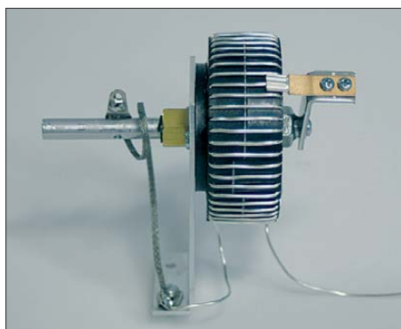
Bild 4: Der Aufbau der schaltbaren Ringkernspule muss sehr sorgfältig erfolgen.
