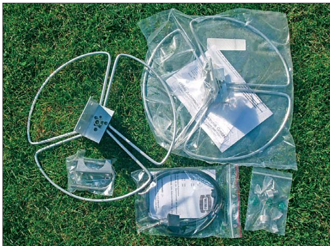
Bild 1: Zwei Big-Wheel-Antennen für 70 cm, die links bereits ausgepackt; vorn die Phasenleitung zum Stocken der beiden Antennen – alles von [3] geliefert
