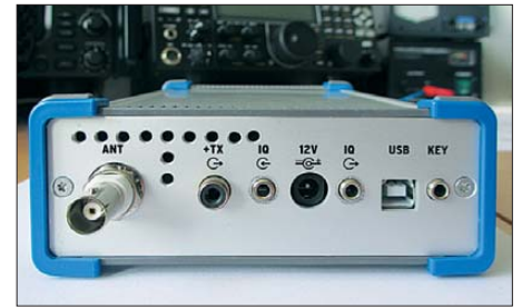
Bild 5: Rückwand des FA-SDR-Transceivers mit Lüftungsbohrungen
