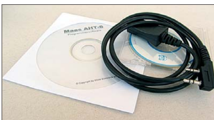
Programmierkabel und -software sind optional, aber nützlich zum Belegen der 199 Speicherkanäle.
