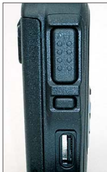
Bild 3: Ein ganzes Arsenal von Buchsen bietet die rechte Seite: für Mikrofon und Lautsprecher in bekannter Norm, Datenkabel und Lade- bzw.
