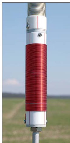
Bild 4: Verlängerungs- spule für das 80-m-Band
