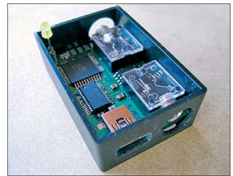
Bild 2: Bestückte Platine im handlichen Gehäuse des CW-Decoders Fotos: DL8UZ
