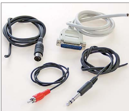
Bild 4: Konfektionierte Kabelstücke können eine gute Grundlage für den Selbstbau sein. Sie lassen sich aus handelsüblichen Verbindungskabeln der Audio- und Computertechnik gewinnen. Fotos: Red. FA
