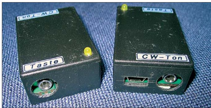
Bild 1: Front- und Rückseite der SMD-Version des CW-Decoders
