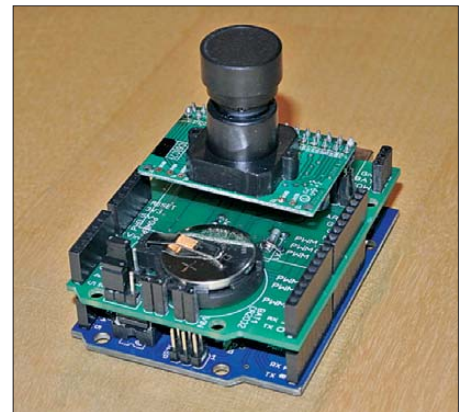
Bild 3: Das selbst gebaute Shield lässt sich auf beliebige Arduino-Boards , hier auf ein Arduino Duemilanove , aufstecken. Fotos, Screenshot: OE1RIB
