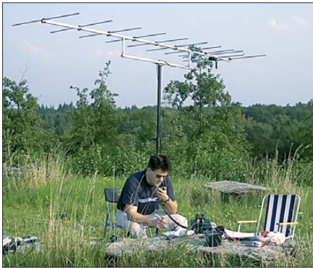
Bild 1: DJ3TZ/p beim Portabelbetrieb mit einem Bleigel-Akkumulator als Stromquelle
