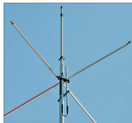
Die vier Antennenstäbe bilden die Dachkapazität der Antenne. Die übergestülpten, leicht drehbaren Kabelkanäle bieten Vögeln keinen Halt mehr. Der Trick lässt sich auch bei anderen Antennen anwenden. Foto: DK4PL
