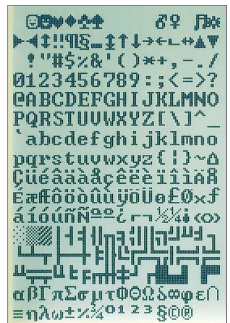
Bild 3: Grafikgrundformen und Zeichensatz des Displays
