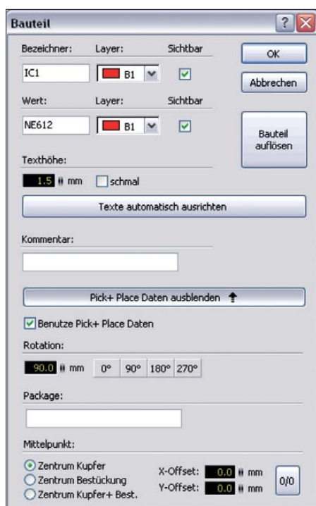
Bild 6: Zentraler Punkt für den Beschriftungsdruck, die Stückliste und das Eingeben von Pick+Place-Daten ist das beim Ablegen eines Bauteils angezeigte Fenster Bauteil . Es öffnet sich auch nachträglich per Doppelklick auf das Bauelement.
