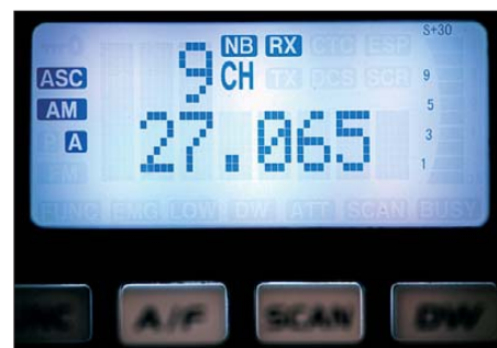
Bild 2: Das kleine Display des xm 4006e zeigt eine Vielzahl von Einstellungen, darunter neben dem Kanal auf Wunsch auch die Frequenz.
