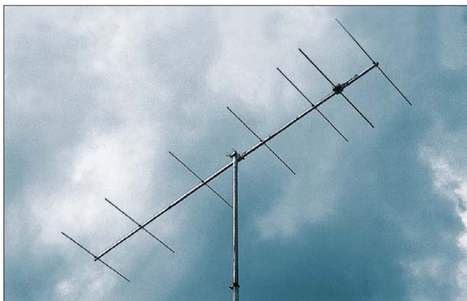
Bild 1: Die 7-Element-28-Ω-Yagi als eine der am meisten nachgebauten Antennen
