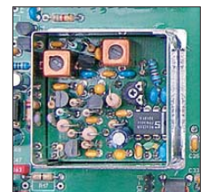
Bild 10: ZF-Verstärker im Weißblechgehäuse auf der Grundplatte
