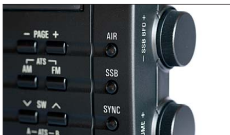
Bild 5: Als Besonderheiten bietet der PL-660er SSB und Sync mit wählbaren Seitenbändern sowie das VHF-Flugfunkband.
