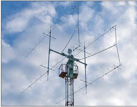
Bild 6: IK1UWL ist mit einer Gruppe von vier 14-Element-Kreuz-Yagis aktiv. Deshalb kann er bei MAP65 sowohl den horizontalen als auch den vertikalen Signalanteil verarbeiten.
