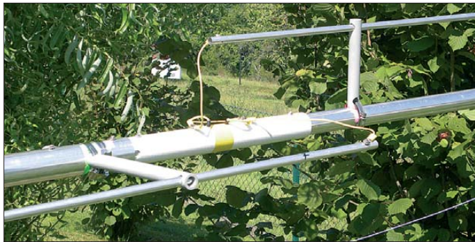
Bild 1: Isoliertes Mittelstück und Befestigung der äußeren Aluminiumrohre
