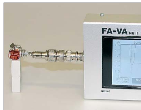
Bild 4: Resonanzmessung eines induktiv gekoppelten Schwingkreises (l.) mit der kleinen Koppelspule aus dem MFJ-66-Spulen-satz; das SWV-Minimum bedeutet „Dip“, hier zur besseren Sichtbarkeit am FA-VA gezeigt.
