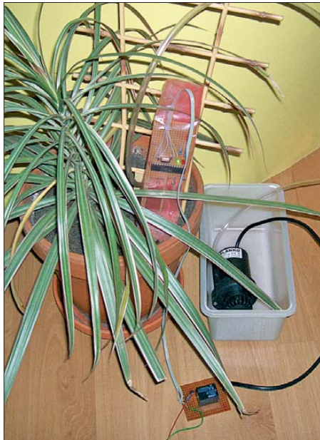
Bild 1: Versuchsaufbau des in einer Plastiktüte untergebrachten Bodenfeuchtesensors mit der Pumpe im Wasserbehälter und ihrer Spannungsversorgung Foto: Sander
