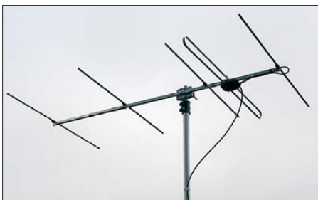
Bild 5: 5-Element-50-Ω-Yagi mit Faltdipol, industriell gefertigt von Konni-Antennen [8]
