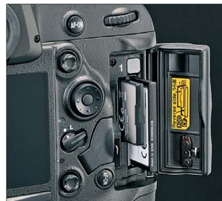
Bild 4: In Nikons Profikamera D4 lassen sich neben herkömmlichen CF-Karten (hinten) erstmals auch die neuen XQD-Speicherkarten verwenden.
